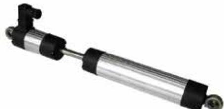
Οι γραμμικές παλμογεννήτριες χρησιμοποιούνται για τον εντοπισμό της θέσης κάποιου κινητού σημείου σε μια μηχανολογική κατασκευή κίνησης. Έχουν ακρίβεια από 0,1 mm έως 0,005 mm και μπορούν να καλύψουν διαδρομές από 50 mm μέχρι 750 mm. Διαθέτουν γραμμικά ρουλεύματα κίνησης και η ταχύτητα μετατόπισης φτάνει τα 3 m/s.
