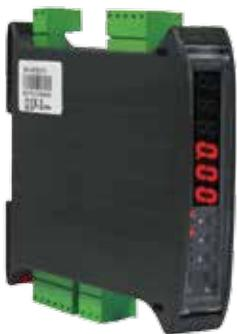
Συμπαγής πολυλειτουργικός μεταδότης & ενδεικτικό ζύγισης για άμεση ανάγνωση και διάγνωση του συστήματος ζύγισης. Τοποθετείται σε ράγα, χρησιμοποιείται σε ένα ευρύ φάσμα επικοινωνιών, είναι εύχρηστο και έχει αδιάβροχο πληκτρολόγιο 5 πλήκτρων. Διαθέτει, επίσης, πιστοποιητικό CE-M (OIML R-76 / EN45501), MID (OIML R-61)
