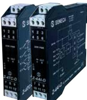
Οι μετατροπείς Α/Δ χρησιμοποιούνται για την αναγνώριση αναλογικών σημάτων (tάση 0-10 Vdc, ρεύμα 0-20 mA, θερμοστοιχεία TC) από μονάδες (πχ PLC) που διαθέτουν μόνο ψηφιακές εισόδους. Τα προϊόντα αυτά είναι υψηλής γαλβανικής απομόνωσης και γίνονται εγκατάσταση σε ράγα. Οι συσκευές τροφοδοτούνται από τάσεις 19...40 Vdc / 19...28 Vac, έχουν πολύ μικρή κατανάλωση και είναι πιστοποιημένες.
