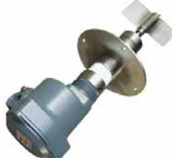
Ανήκει στη σειρά με πτερύγια, για στερεά υλικά και υψηλές θερμοκρασίες. Ενδείκτης στάθμης με πτερύγια μικρού μεγέθους ειδικά κατάλληλος για χρήση σε μικρές δεξαμενές δοσομέτρησης και για λειτουργία σε χώρους με υψηλές θερμοκρασίες. Τα εξαρτήματα που έρχονται σε επαφή με το προϊόντα είναι κατασκευασμένα από ανοξείδωτο χάλυβα. Έκδοση με φλάντζα.
