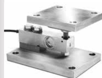
Σετ στήριξης για δυναμοκυψέλες SB ύψους 2000kgr, ανοξείδωτης κατασκευής, εύκολης εγκατάστασης, με ειδική άρθρωση που εξασφαλίζει εξαιρετική ακρίβεια μέτρησης και παρελκόμενα κατάλληλα για ζύγιση σε χοάνες, δεξαμενές και πλατφόρμες. Διαθέτει ρύθμιση ύψους για βέλτιστη ευθυγράμμιση. Οι εκδόσεις αντιεκρηκτικού τύπου ATEX για ζώνες 1 & 21, 2 & 22 μπορούν να εφαρμοστούν σε χώρους υψηλής επικινδυνότητας.
