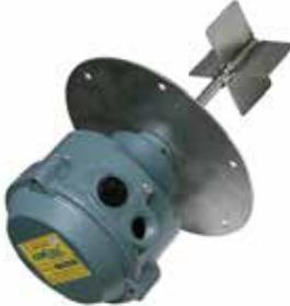
Ανήκει στη σειρά με πτερύγια, για στερεά και διαβρωτικά υλικά. Αυτή η μονάδα στιβαρής κατασκευής είναι πολύ ασφαλής και είναι ειδικά σχεδιασμένη για δύσκολες συνθήκες εργασίας και συνεχείς κύκλους. Τα εξαρτήματα που έρχονται σε επαφή με το προϊόν είναι κατασκευασμένα από ανοξείδωτο χάλυβα. Έκδοση με φλάντζα.
