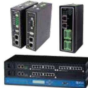
Τα βιομηχανικά Gateways μετατρέπουν την επικοινωνία που πραγματοποιείται με κάποιο βιομηχανικό πρωτόκολλο σε κάποιο άλλο. Με τη μέθοδο αυτή γίνεται δύναται η συμμετοχή συσκευών που χρησιμοποιούν διαφορετικά πρωτόκολλα (Profinet, Ethernet/IP, Modbus, OPC UA και πολλά άλλα) στο ίδιο δίκτυο επικοινωνίας.
