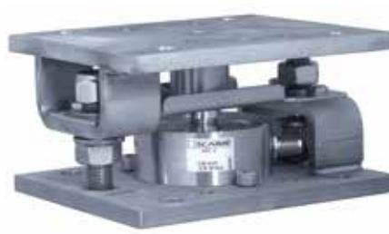
Βάσεις στήριξης για δυναμοκυψέλες R10 ως 30t, ανοξείδωτης κατασκευής, προστασίας IP68, συμπαγός σχεδιασμού και εύκολης εγκατάστασης, κατάλληλες για δεξαμενές, δοχεία και σιλό. Διαθέτουν δυνατότητα εύκολης αντικατάστασης load cell, σύστημα προστασίας πλευρικών δυνάμεων και απορρόφησης δονήσεων & κρούσεων.
