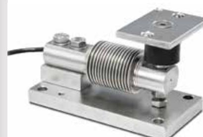
Σετ στήριξης για δυναμοκυψέλες FXC & FXD ως 500kgr, κατασκευής από ανοξείδωτο χάλυβα, κατάλληλη για ζύγιση σε χοάνες δεξαμενές και αναδευτήρες, με ασφάλεια κλειδώματος.
