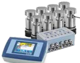
KIT που αποτελείται από ενδείκτη βάρους με οθόνη αφής και ενσωματωμένο ειδικό πρόγραμμα για γεφυροπλάστιγγες, 6 ή 8 ανοξείδωτες αναλογικές δυναμοκυψέλες RCPT προστασίας IP68 και κυτίο σύνδεσης με αντικεραυνική προστασία. Συμπεριλαμβάνει έγχρωμη οθόνη αφής προστασίας IP65 με μηνή και επικοινωνία με Η/Υ και εκτυπωτή, 2 εισόδους και 4 έξοδους, πρόγραμμα κατάλληλο για ζύγιση οχημάτων και διαχείριση γεφυροπλάστιγγας με είσοδο / έξοδο προϊόντων.
