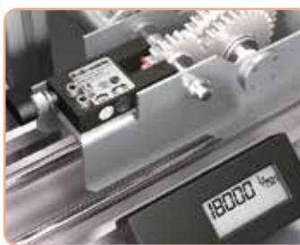
Μέτρηση της ταχύτητας των μικρών πλαστικών γραναζιών
