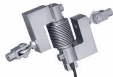
Kit στήριξης εφαρμογών εφελκυσμού για δυναμοκυψέλες F60X ως 200kgr, επιψευδαργυρωμένου χάλυβα, ειδικά σχεδιασμένο για μηχανολογική μετατροπή των δυναμοκυψελών με σκοπό την εγκατάσταση τους σε γεφυροπλάστιγγα και χοάνη ζύγισης.
