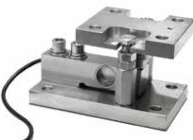
Σετ στήριξης για δυναμοκυψέλες SBX / SBK ως 2500kgr, επινικελωμένην. Διαθέτει άνω πλάκα με σφαιρικό σύνδεσμο για βέλτιστη ακρίβεια, σύστημα κλειδώματος για εύκολη μεταφορά και συντήρηση, δυνατότητα εύκολης και γρήγορης εγκατάστασης - αφαίρεσης των δυναμοκυψελών και ρύθμιση ύψους για βέλτιστη ευθυγράμμιση.
