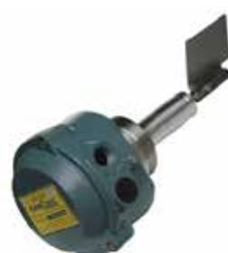
Ανήκει στη σειρά με πτερύγια, για στερεά και διαβρωτικά υλικά. Αυτή η μονάδα στιβαρής κατασκευής είναι πολύ ασφαλής και είναι ειδικά σχεδιασμένη για δύσκολες συνθήκες εργασίας και συνεχείς κύκλους. Τα εξαρτήματα που έρχονται σε επαφή με το προϊόν είναι κατασκευασμένα από ανοξείδωτο χάλυβα. Έκδοση με αρσενικό σπείρωμα 2" 1/2 Gas.
