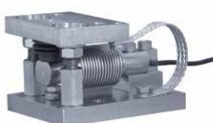
Βάσεις στήριξης για δυναμοκυψέλες F60X, SK30A, SK30X ως 5t, ανοξείδωτης κατασκευής ή με επίστρωση ψευδάργυρου ιδανικές για δεξαμενές πλοίων και χοάνες ζύγισης. Διαθέτουν σταυρό για πρόληψη και προστασία μετατόπισης και κεφαλή σταθεροποίησης για υψηλή ακρίβεια ζύγισης.
