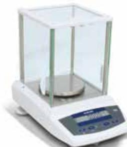
Ζυγαριά υπερυψηλής ακρίβειας για χρήση στο φαρμακευτικό κλάδο σε εργαστηριακό και βιομηχανικό επίπεδο. Συμπαγή και ευέλικτη με γαλάνιο προστατευτικό καπάκι για αποφύγη παρεμβολών από ρεύματα αέρα. Ο ενδείκτης διαθέτει οθόνη LCD, 7 ψηφίων, ύψους 15 mm και αδιάβροχο πληκτρολόγιο μεμβράνης 4 πλήκτρων.
