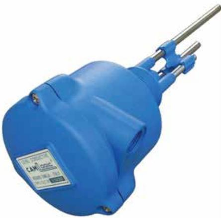
Η μέθοδος που χρησιμοποιούν αυτά τα όργανα βασίζεται στην αγωγιμότητα των υγρών που έρχονται σε επαφή με τις βέργες ανοξείδωτου χάλυβα του αισθητηρίου. Η τοποθέτηση τους γίνεται είτε οριζόντια, είτε κάθετα, με τον περιορισμό, κατά την παροχή υγρού να μην υπάρχει άμεση επαφή του υλικού που εισέρχεται με τις βέργες του οργάνου, προκαλώντας εσφαλμένη ανίχνευση.
