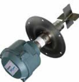
Ανήκει στη σειρά με πτερύγια, για στερεά υλικά και υψηλές θερμοκρασίες. Ενδείκτης στάθμης κατάλληλος για λειτουργία σε χώρους με υψηλές θερμοκρασίες. Τα εξαρτήματα που έρχονται σε επαφή με το προϊόν είναι κατασκευασμένα από ανοξείδωτο χάλυβα. Έκδοση με φλάντζα.
