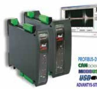
Ο ελεγκτής ζύγισης αυτός μετατρέπει έναν αισθητήρα σε ευφύές αυτόματο σύστημα ανάλυσης βάρους. Είναι κατάλληλος για εφαρμογές πληρώσεων, δοσομέτρησης, συνεχόμενης ζύγισης, ταινιοζύγων, ζύγισης και απόρριψης. Έχει τη δυνατότητα πλήρους επεξεργασίας σήματος με αυτόματη υπολογισμό βάρους και εφαρμογής φίλτρων θορύβου για ακύρωση κραδασμών. Το ειδικό λογισμικό eNod View επιτρέπει την βαθμονόμηση και τον προγραμματισμό και αποτελεί ισχυρό εργαλείο για την απόκτηση και ανάλυση του σήματος.
