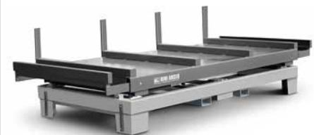
Πλατφόρμα με 4 δυναμοκυψέλες, κατάλληλη για ζύγιση μεταλλικών επιφανειών, ράβδων, σωληνών και πλακών σε βιομηχανικές και εμπορικές εφαρμογές. Η τυπική έκδοση είναι με δυναμοκυψέλες με δείκτη προστασίας IP65. Στιβαρή κατασκευή από χάλυβα, και επιφάνεια ζύγισης με ράβδους στηρίξης, σταθερές άκρες και αναδιπλούμενες άκρες στην πλευρά του χειριστή. Ταλάντωση πλατφόρμας σε χαλύβδινες μπάλες και κλειδαρίες ταλάντωσης για την αποφυγή ανατροπών.
