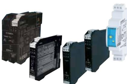
Οι μετατροπείς μετρήσεων ενέργειας χρησιμοποιούνται για τη μέτρηση των τιμών τάσης και έντασης, εναλλασσόμενου και συνεχούς ρεύματος και τη μετατροπή των τιμών αυτών σε βιομηχανικά σήματα αναλογικά (4...20 mA ή 0...10 Vdc). Παράλληλα, κάποιες εκδόσεις διαθέτουν δυνατότητα σειριακής επικοινωνίας. Η ρύθμιση των συσκευών γίνεται μέσα από λογισμικό υπολογιστή και συστοιχία διακοπών (dip switch). Οι μονάδες αυτές χαρακτηρίζονται τόσο από υψηλή ακρίβεια, όσο και από υψηλή γαλβανική απομόνωση.
