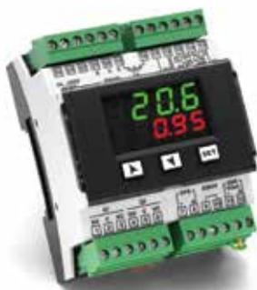
Το όργανο ράγας αυτό διαθέτει μια αναλογική είσοδο που μπορεί να διαχειρίστε 18 διαφορετικά είδη σημάτων, 2 έξοδους relay και 1 έξοδο που μπορεί να χρησιμοποιηθεί σαν αναλογική ή solid state relay. Έχει ενσωματωμένο PID control, διασύνδεση επικοινωνίας RS485 και τροφοδοτείται από τάση 24 - 230 Vac/dc.
