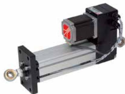
Τα συστήματα αυτά οδηγούνται από τα όργανα ελέγχου και διόρθωσης θέσης για εύκαμπτα υλικά και κινούν την εκάστοτε μηχανολογική κατασκευή που είναι υπεύθυνη για την επαναφορά του υλικού στη σωστή θέση. Οι διάφορες εκδόσεις μπορούν να καλύψουν διαδρομές από (-25) - (+25) mm μέχρι (-100) - (+100) mm, και μεγιστες δυνάμεις από 1100 N έως 10000 N.
