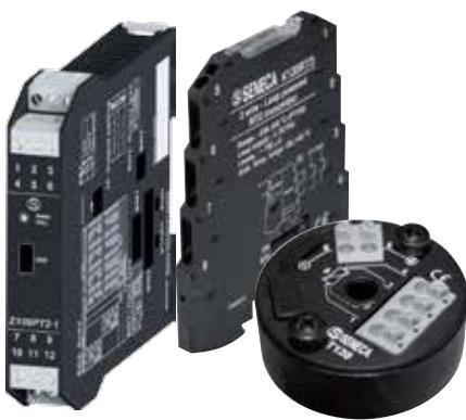
Οι μετατροπείς αισθητήρων θερμοκρασίας χρησιμοποιούνται για τη θερμομέτρηση με χρήση θερμοστοιχείου (TC) ή θερμοαντίστασης RTD, μετατρέποντας την τιμή σε αναλογικό σήμα τάσης 0-10 Vdc ή ρεύματος 0-20 mA. Τα προϊόντα αυτά είναι υψηλής γαλβανικής απομόνωσης και γίνονται εγκατάσταση σε ράγα και τοποθετούνται στην κεφαλή συνδέσεων του αισθητήρα θερμοκρασίας. Οι συσκευές τροφοδοτούνται από τάσεις 19...40 Vdc / 19...28 Vac. Όλα τα προϊόντα έχουν πολύ μικρή κατανάλωση και είναι πιστοποιημένα.
