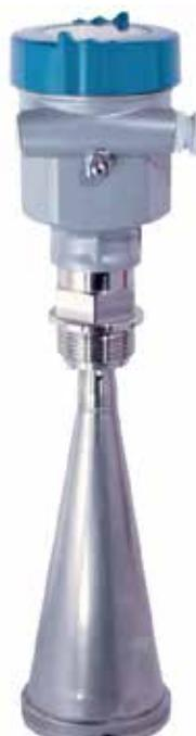
Το RPL58 είναί είνας αισθητήρας ραντάρ για συνεχή μέτρηση στερεών. Κατάλληλο για εφαρμογή σε σιλό και αποθήκευση σε μεγάλα υπόστεγα, επίσης σε σκληρές συνθήκες εργασίας. Κατάλληλο για μέτρηση στάθμης σε δεξαμενές με σύνδεση σπειρώματος ή φλάντζας 1 ½ "G.
