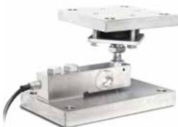
Σετ στήριξης για δυναμοκυψέλες SB από 300kgr ως 2000kgr, κατασκευής από γαλβανισμένο χάλυβα, εύκολης εγκατάστασης, με ειδική ταλάντωση σφαιρικού συνδέσμου που εξασφαλίζει εξαιρετική ακρίβεια μέτρησης, κατάλληλα για ζύγιση σε χοάνες δεξαμενές και πλατφόρμες.
