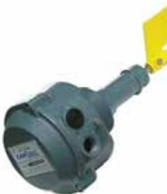
Ανήκει στη σειρά με πτερύγια, για στερεά υλικά. Αυτή η μονάδα στιβαρής κατασκευής είναι πολύ ασφαλής και είναι ειδικά σχεδιασμένη να χρησιμοποιείται σε δύσκολες συνθήκες εργασίας και συνεχείς κύκλους. Έκδοση με αρσενικό σπείρωμα 2" 1/2 Gas.
