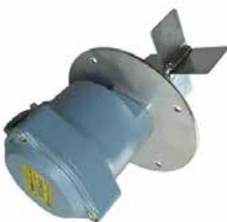
Ανήκει στη σειρά με πτερύγια, για στερεά και διαβρωτικά υλικά. Ενδείκτης στάθμης με πτερύγια μικρού μεγέθους ειδικά κατάλληλος για χρήση σε μικρές δεξαμενές δοσομέτρησης. Τα εξαρτήματα που έρχονται σε επαφή με το προϊόντα είναι κατασκευασμένα από ανοξείδωτο χάλυβα. Έκδοση με φλάντζα.
