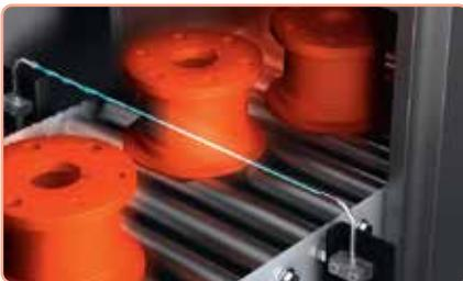
Ανίχνευση με οπτική ίνα υψηλής θερμοκρασίας
