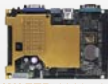
WAFAER-6820-733 3.5"Embedded SBC Transmeta TM5800 733MHz CPU
